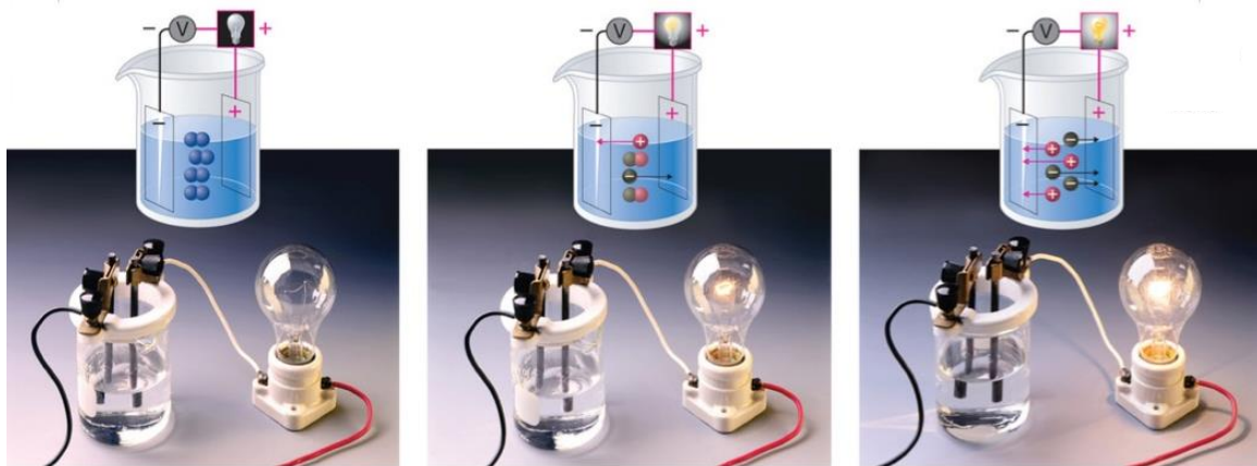
Slika 6. Ilustracija provodljivosti neelektrolita (levo), slabog elektrolita (sredina) i jakog elektrolita (desno)
